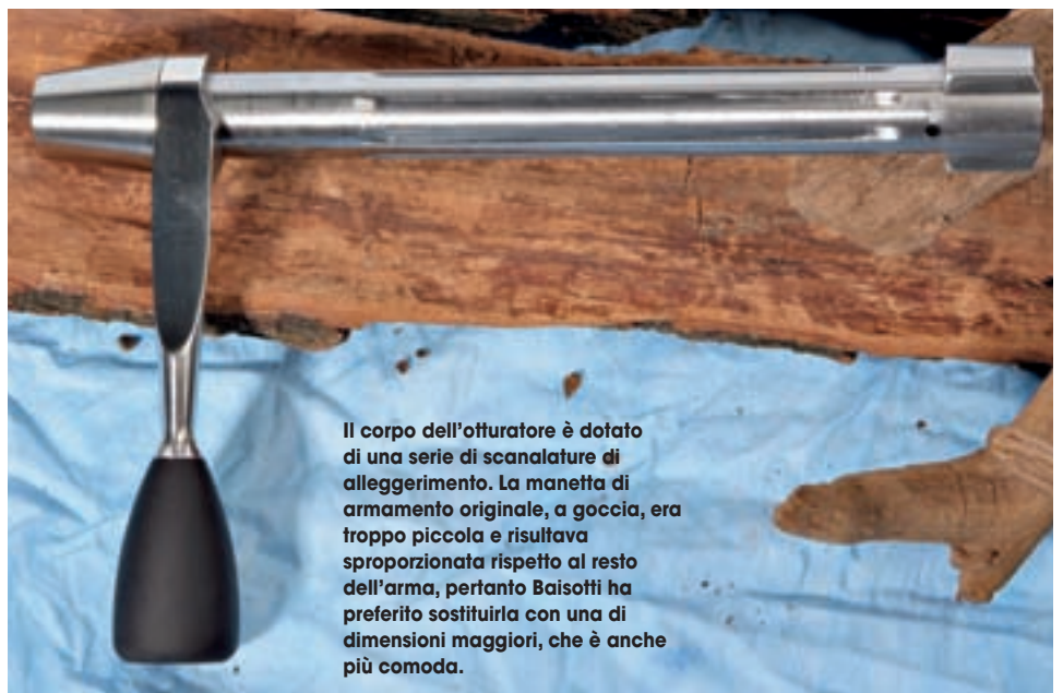
L'azione è dotata di recoil lug e ha i fori filettati per tre tenoni di fissaggio alla calciatura.
